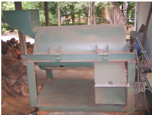
Gambar 1. Mesin pemukul sabut kelapa
