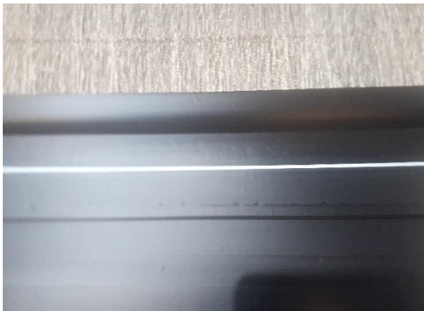
Gambar 10. Hasil uji coba alat marking menggunakan cat warna putih
