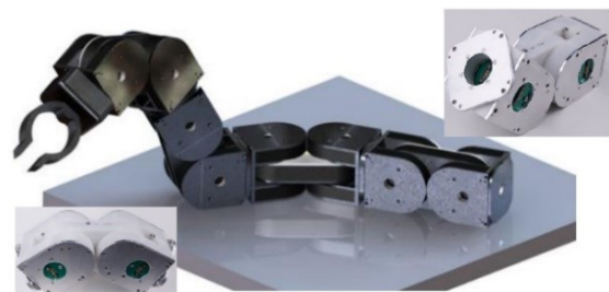
Gambar 3. Pola gerakan menekuk tubuh robot ular untuk menghasilkan gerak linier [11]
