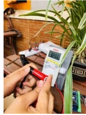
Gambar 13. Tegangan awal battery Li-ion 3,7V
