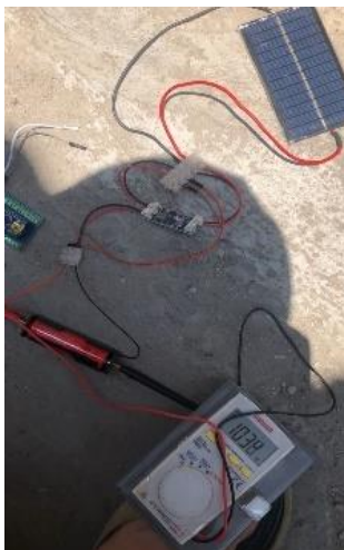
Gambar 17. Hasil tegangan saat battery sedang recharge
