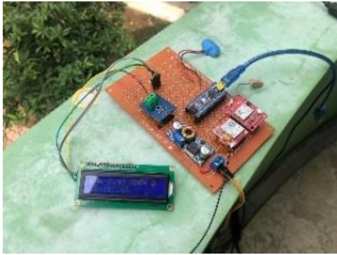
Gambar 10. Rangkaian elektrik smart patok batas negara
