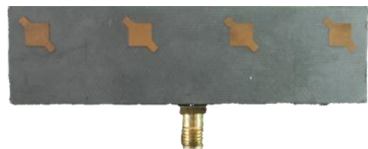
Gambar 9. Antena mikrostrip 1x4 tampak depan
