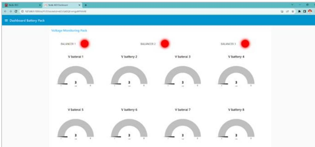
Gambar 6. Antarmuka untuk pemantauan tegangan baterai
