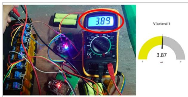
Gambar 9. Perbandingan nilai pengukuran sensor dengan multimeter
