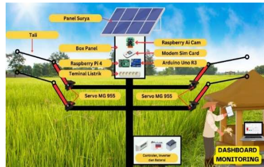
Gambar 5. Instalasi Pengembangan Alat
