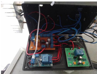
Gambar 5. Rangkaian kontrol pada sistem PJU
