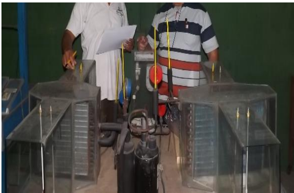
Gambar 3. Mesin pendingin kompresi uap berkapasitas daya kompresor 875 W
