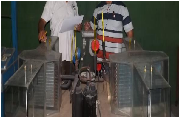
Gambar 3. Mesin pendingin kompresi uap berkapasitas daya kompresor 875 W
