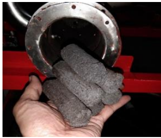
Gambar 6. Briket 6 buah pada ruang bakar
