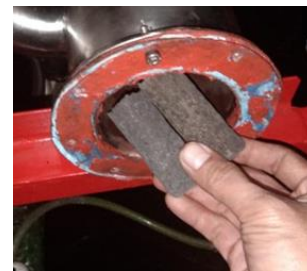
Gambar 4. Briket 2 buah pada ruang bakar
