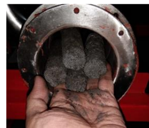
Gambar 5. Briket 4 buah pada ruang bakar
