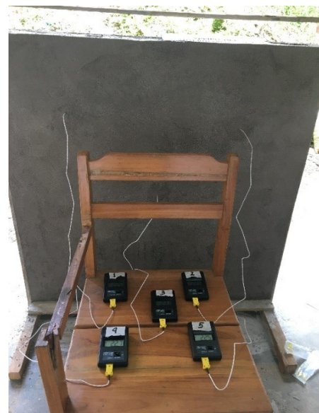
Gambar 4. Pengujian sisi tidak terekspose api
