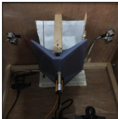
Gambar 5. Perakitan komponen bagian penghitung volume sampah
