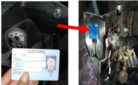
Gambar 5. Pengujian RFID reader
