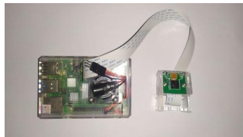
Gambar 6. Rangkaian Raspberry Pi 4 dan kamera
