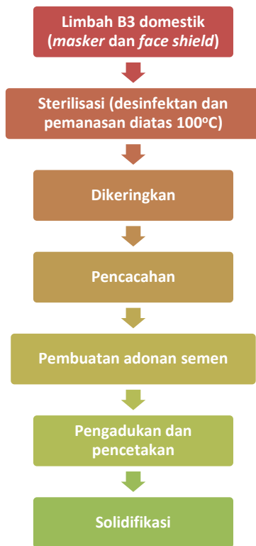
Gambar 1. Proses solidifikasi limbah B3 rumah tangga
