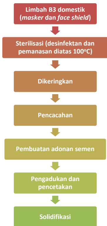
Gambar 1. Proses solidifikasi limbah B3 rumah tangga
