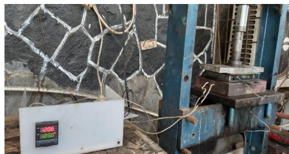
Gambar 4. Teknik hot compaction pada proses produksi komposit grafit-PF
