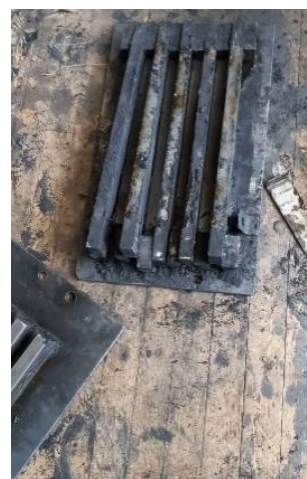
Gambar 5. Komposit grafit-PF yang akan dilepaskan dari cetakan
