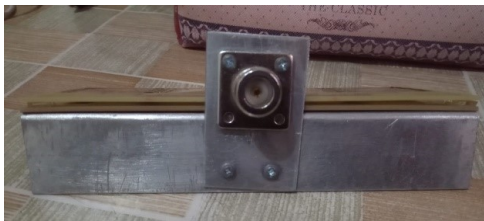
Gambar 10. Pemasangan konektor kepada plat penghubung
