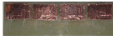
Gambar 8. Antena mikrostrip tampak depan
