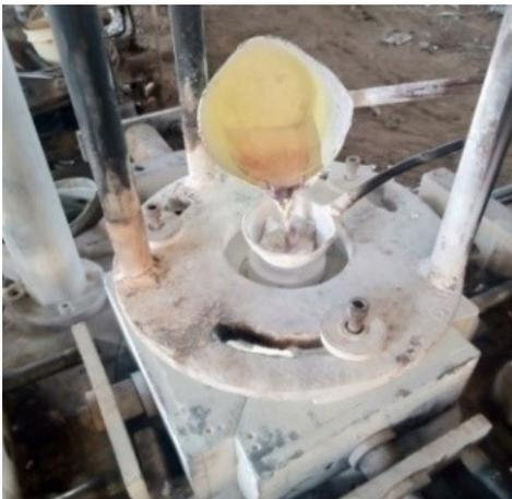
Gambar 2. Proses pengecoran menggunakan metode *gravity casting*
