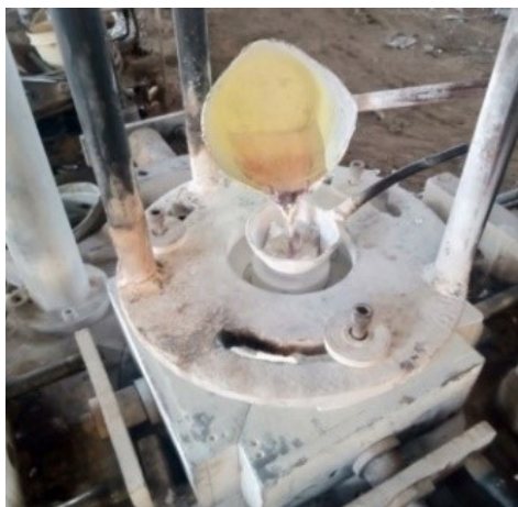
Gambar 2. Proses pengecoran menggunakan metode gravity casting
