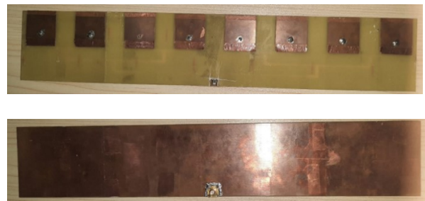
Gambar 6. Antena mikrostrip 8 elemen coaxial probe tampak depan dan belakang
