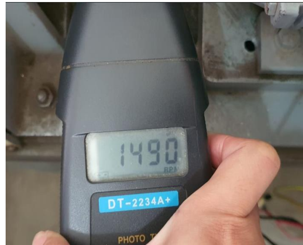
Gambar 12. Hasil monitoring kecepatan motor tanpa beban dengan pengasutan D.O.L
